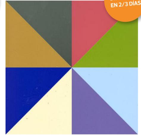
El acetato de celulosa de extrusión de colores es el único plástico con orígenes vegetales como la flor del algodón y la pulpa de la madera, a los que se le añaden aditivos, plastificantes y colorantes. Su valor radica en su flexibilidad, dureza, resistencia e impermeabilidad al agua. Se fabrica partiendo de los gránulos de celulosa. Puede ser cortado y grabado a láser y su aplicación se basa en la bisutería, las artes decorativas y la restauración.
