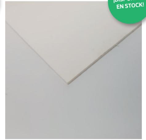
El **polipropileno espumado** un polímero termoplástico blanco, muy parecido al PVC Forex pero sin contener PVC, por lo que es especialmente indicado para el corte por láser en sustitución del forex, puesto que los cantos no quedan amarillentos y no es tóxico. Se puede utilizar para cualquier aplicación que requiera un material flexible o para curvas de nivel en maquetas y en rotulación, además de otras muchas aplicaciones creativas. No es recomendable el grabado, solo el corte.
