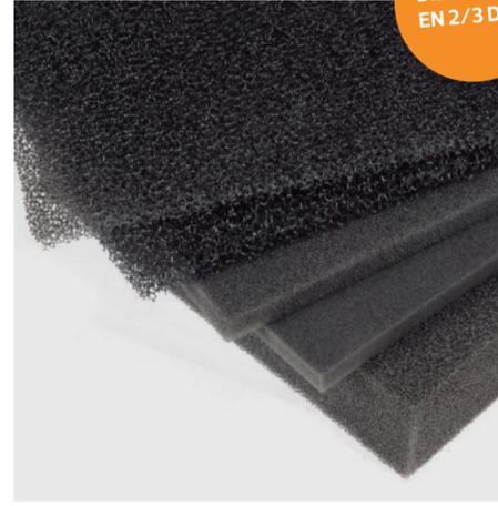
La **espuma filtrante aire** 34 kg/m<sup>3</sup> (porosidad 10 a 60) es de color negro, se fabrica en poliuretano y se reticula sobre una base de poliéster. Es un material flexible muy adecuado para sistemas de aire acondicionado y climatización. Al ser una espuma de célula abierta permite - en función de su densidad - una filtración eficaz.
