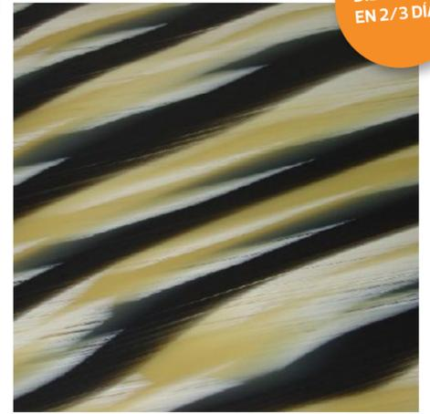
El **acetato de celulosa asta** es el único plástico con orígenes vegetales como la flor del algodón y la pulpa de la madera, a los que se le añaden aditivos, plastificantes y colorantes. Su valor radica en su flexibilidad, dureza, resistencia e impermeabilidad al agua. Puede ser cortado y grabado a láser y su aplicación se basa en la bisutería, las artes decorativas y la restauración.
