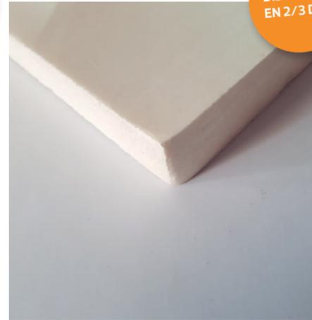
El **EPS o poliestireno extruido** se usa mayoritariamente para rótulos, maquetas y estructuras de grandes dimensiones, que no requieran resistencia. Puede fresarse y cortarse con hilo caliente pero no es posible su corte o grabado con corte láser. Para mejores acabados puede lijarse, pintarse o forrarse con materiales más nobles. Al ser de mayor densidad que el corcho blanco, se consiguen resultados más lisos y mejores acabados.
